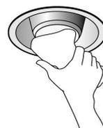
図 3-5-2 天井付吸込み口の清掃例
